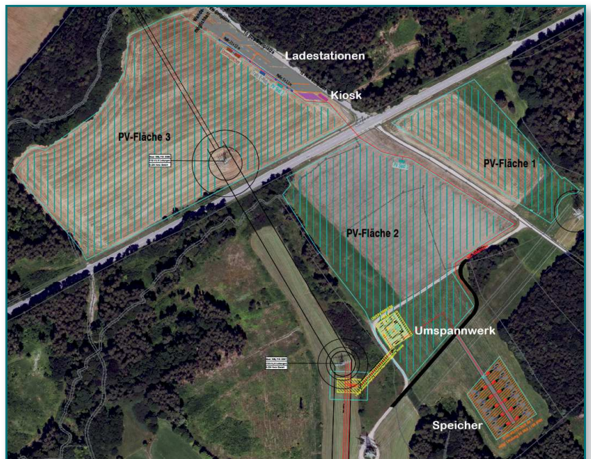
Die geplanten PV-Flächen, Speicher und Ladestationen
